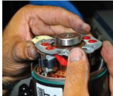
o motor com cuidado no equipamento e organizada, lembrando-se de lavar o conjunto com água ou solventes e verificar se os apertos dos terminais e cabos estão adequados.
