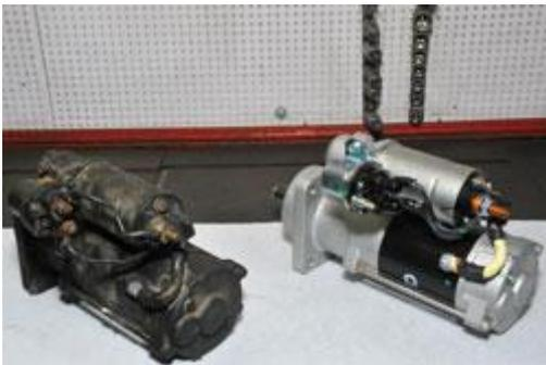
Caso seja necessário retirar o motor de partida da unidade para a manutenção, é recomendável desligar a chave geral e posteriormente localizar o motor de partida do equipamento, que muitas vezes pode interferir em outros componentes e, por isso, requer uma desmontagem cuidadosa e organizada.
