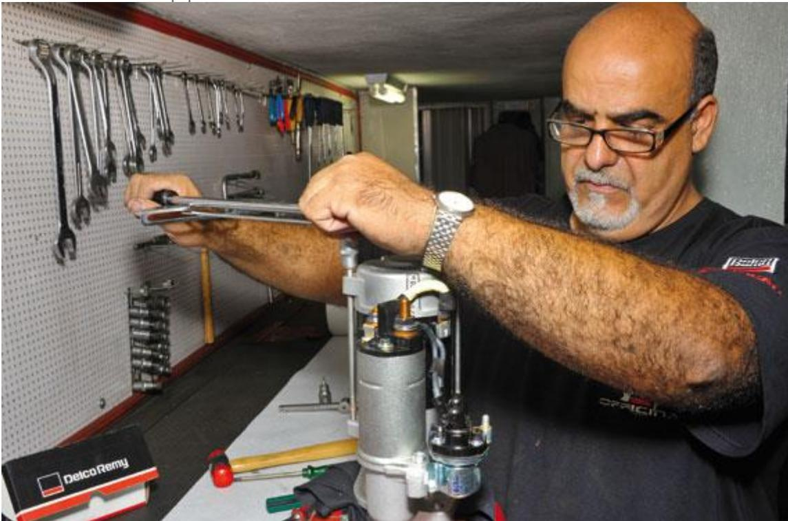
Responsável pelo acionamento do motor a combustão, o motor de partida (também conhecido como motor de arranque) é um componente vital no funcionamento das máquinas. Tanto em caminhões como em equipamentos pesados, o princípio de funcionamento é o mesmo, assim como a origem dos problemas.
