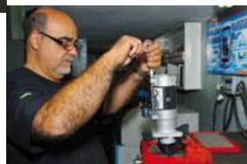
integridade do sistema elétrico antes de desconectar o polo negativo da bateria. Em seguida, desconecte o motor de partida e leve-o a uma bancada de testes;
